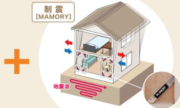
地震エネルギーを装置が吸収。建物の揺れが抑えられるため、 構造躯体へのダメージが軽減されます。
